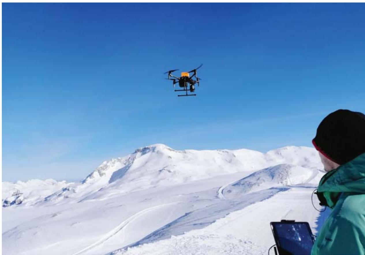
Ce drone autonome est capable de localiser les victimes d'avalanche grâce à son DVA. NIVITEC
